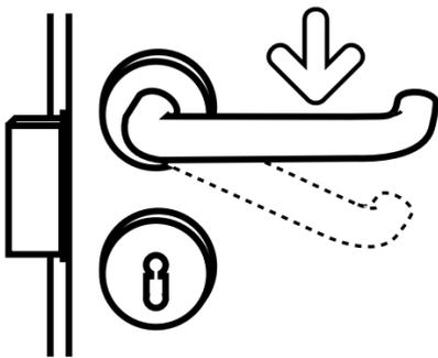
*Maçanetas tipo alavanca, que são de fácil utilização, podendo ser acionada até com o cotovelo. Esse tipo de equipamento facilita a abertura de portas no caso de incêndios, não sendo necessário girar a mão.*
