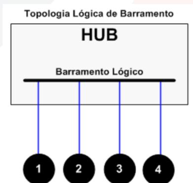
Figura 18. HUB: aparência de estrela, funcionamento de barramento.
