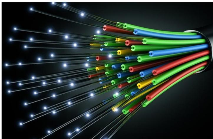
Cabos de fibra ótica possuem **núcleo de vidro** para propagar a luz. E, uma vez que estamos falando de luz, ela não sofre interferência eletromagnética, e pode viajar distâncias ainda maiores.
