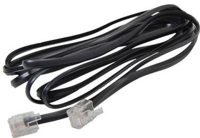
Você é da geração raiz ou da geração Nutella? Se for da geração raiz, certamente já viu um cabo de telefone fixo, como esse aí da esquerda. Esse é um dos cabos de par trançado mais famosos. Ele possui um nome técnico, chamado cabo **CAT3** (categoria 3). Ele contém um par de fios de cobre, que era mais do que o suficiente para a telefonia. E essa ponta de plástico recebe um nome também: é o conector **RJ-11**.
