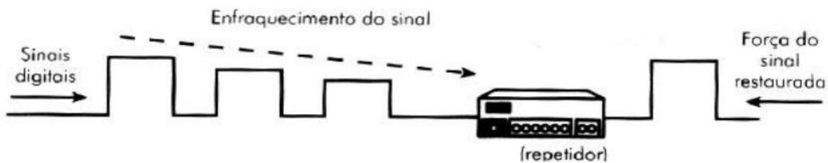
Figura 17. Ganho de sinal oferecido por repetidor: ilustração.
